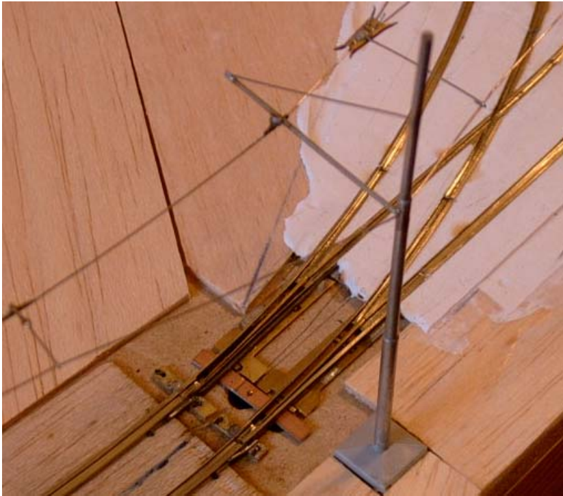
Eine Weiche aus einem Swedtrambausatz – die Streifen unter dem Schienenfuß der Weichenzunge sind hier zu erkennen (Weichenzunge und Streifen sind hier ein Gußteil)
